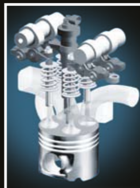
Klepstoters met brede rollagers verminderen weerstand en slijtage
